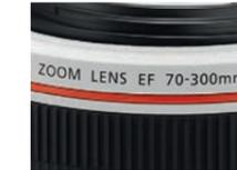
Zoomobjektive ermöglichen die Nutzung verschiedener Brennweiten mit einem einzelnen Objektiv. Dreht man den Zoomring, so verschiebt sich ein Linsenelement innerhalb des Objektivs und verändert damit den Bildausschnitt. Vorteilhaft sind Zoomobjektive vor allem, wenn man schnell auf wechselnde Motive reagieren oder das Ausrüstungsge-
